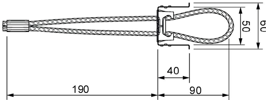
Bild 4: Verwehrkasten mit ausgeklappten Seilschlaufen – Querschnitt
