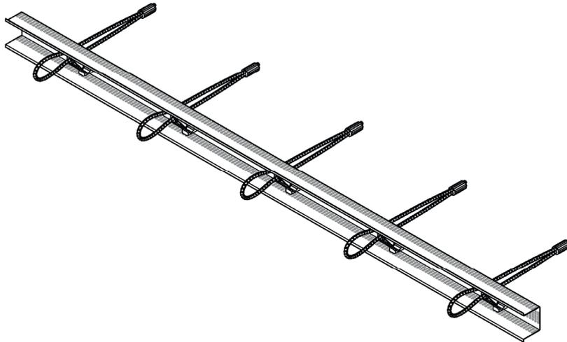
Bild 1: Verwahrkasten mit eingesetzten Seilschlaufen (im Transportzustand eingeklappt)
