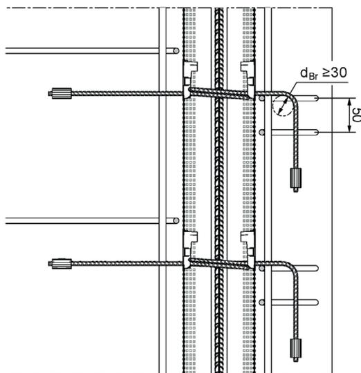
Bild 14: Wand- Wand Verbindung (T-Stoß), Horizontal- und Vertikalschnitt
