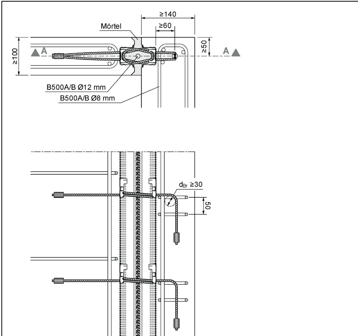
Bild 15: Wand – Wand Eckverbindung, Horizontal- und Vertikalschnitt
