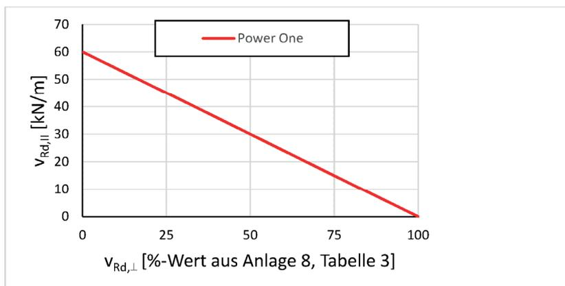
Diagramm 1: Interaktion, sofern keine planmäßige Zugkraftbeanspruchung  $Z_{Ed}$  vorliegt
