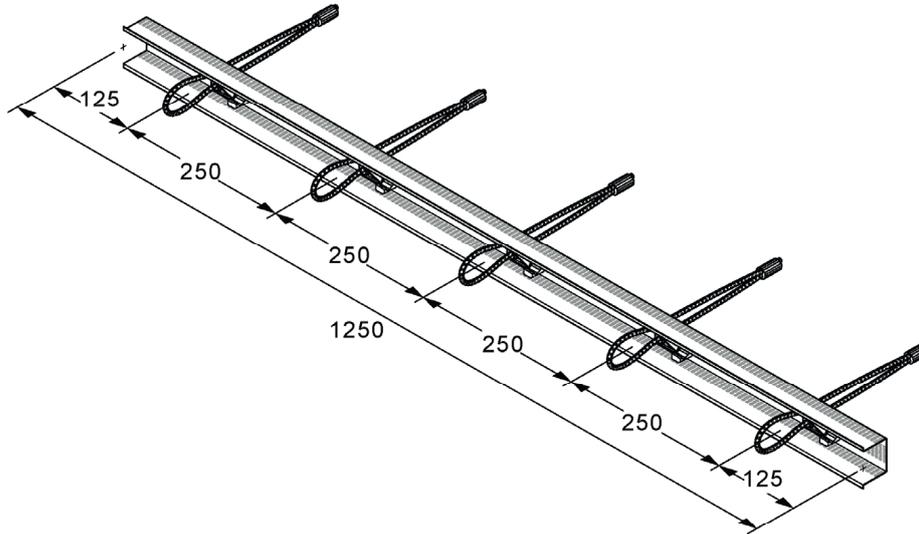
Bild 3: Verwehrkasten mit ausgeklappten Seilschlaufen
