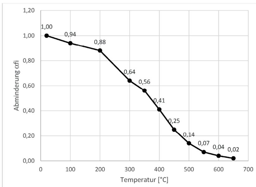
Diagramm 2: Abminderungsfaktoren  $\alpha_{fi}$  in Abhängigkeit der Seiltemperatur
