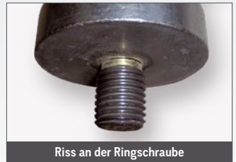
Riss an der Ringschraube
