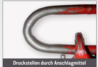
Druckstellen durch Anschlagmittel
