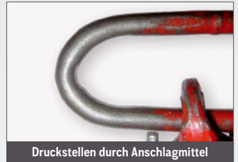
Druckstellen durch Anschlagmittel
