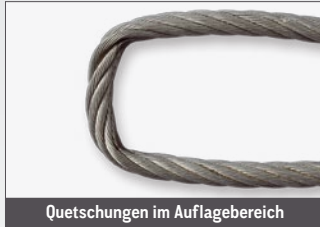
Quetschungen im Auflagebereich
