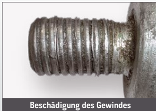
Beschädigung des Gewindes
