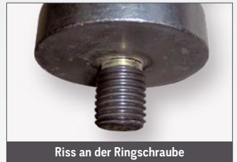
Riss an der Ringschraube
