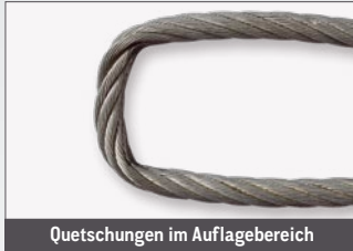
Quetschungen im Auflagebereich
