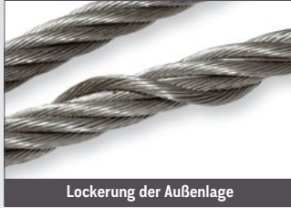
Lockerung der Außenlage
