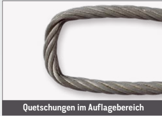
Quetschungen im Auflagebereich
