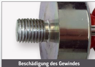
Beschädigung des Gewindes
