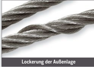
Lockerung der Außenlage
