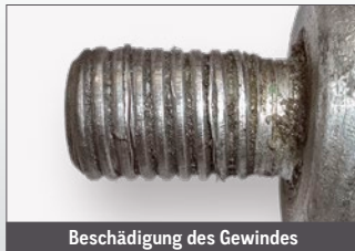
Beschädigung des Gewindes
