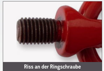
Riss an der Ringschraube
