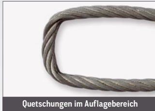
Quetschungen im Auflagebereich
