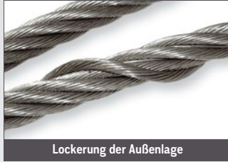
Lockerung der Außenlage
