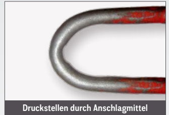
Druckstellen durch Anschlagmittel
