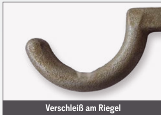
Verschleiß am Riegel
