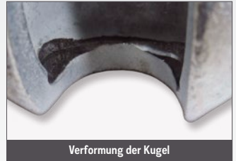
Verformung der Kugel
