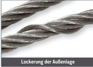
Lockerung der Außenlage
