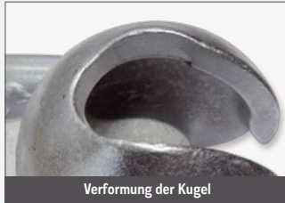
Verformung der Kugel
