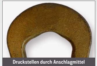
Druckstellen durch Anschlagmittel
